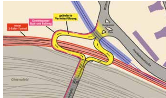
Endzustand des Provisoriums mit Umfahrungsschleifen
