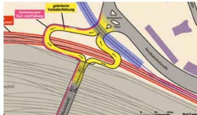
Endzustand des Provisoriums mit Umfahrungsschleifen
